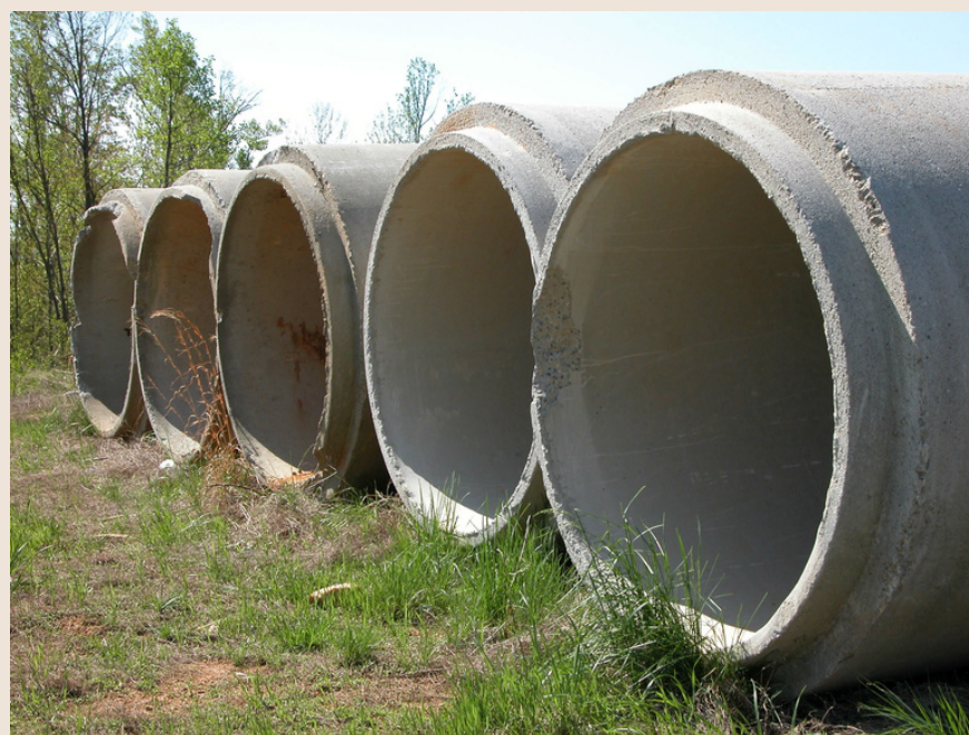
Tubulações para drenagem de águas pluviais urbanas
