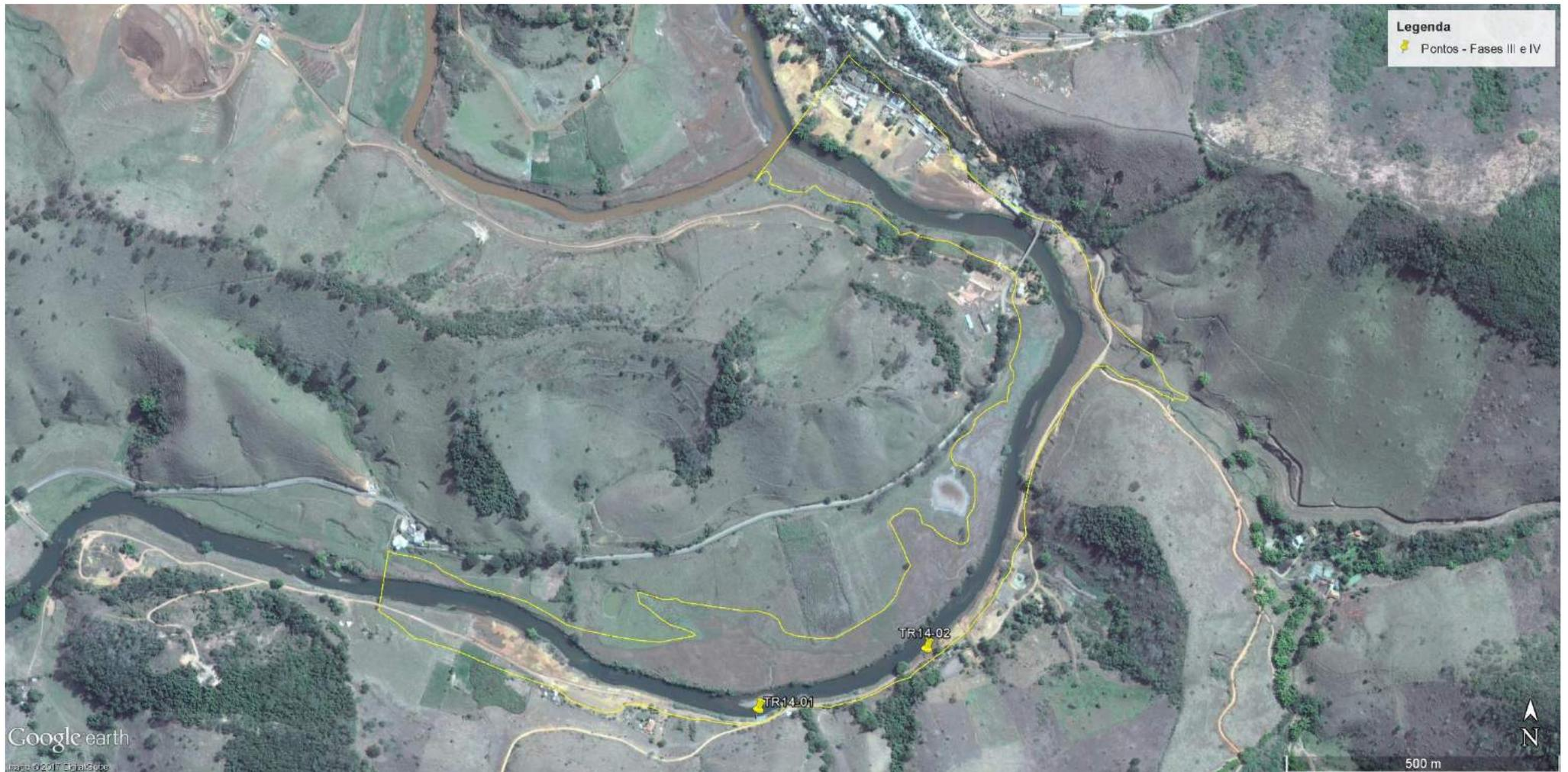
**Descrição:** Ponto localizado no Rio do Carmo a montante do encontro com o Rio Gualaxo do Norte, em área que sofreu o refluxo da lama de rejeito, com o arranque de parte do solo e da vegetação e deposição de rejeito nas duas margens da calha principal, mas também com ravinas e solapamentos nos taludes marginais e erosão laminar na planície. Os trabalhos de recuperação nas margens estão ainda limitados as intervenções iniciais, com obras estruturais e revegetação com *mix* e pastagem.
