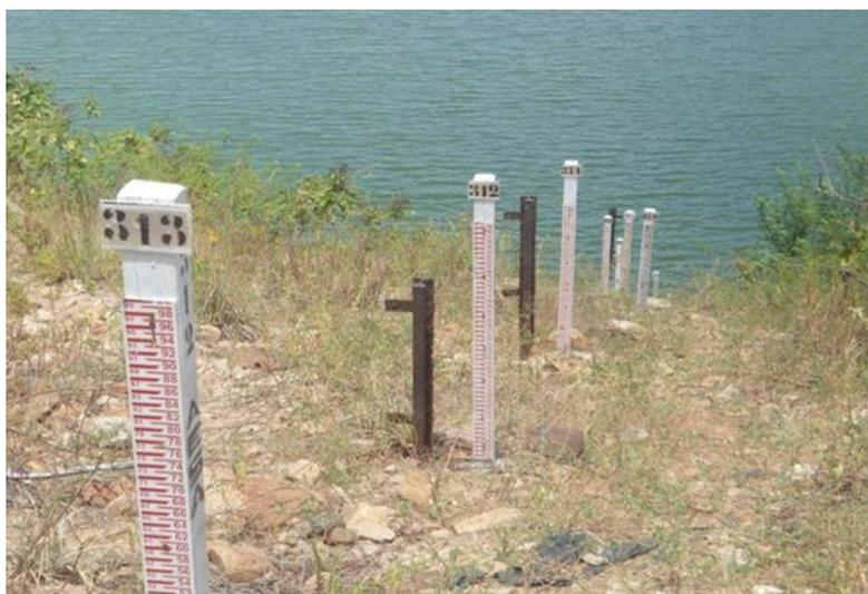
Figura 12: Seção de réguas limnimétricas
